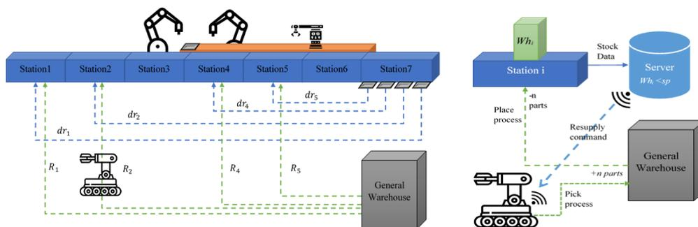
**Figure 7.** a)Traiectoriile CAS pentru aprovizionare/recuperare componente in magazii; b) Aprovizionare cu componente
