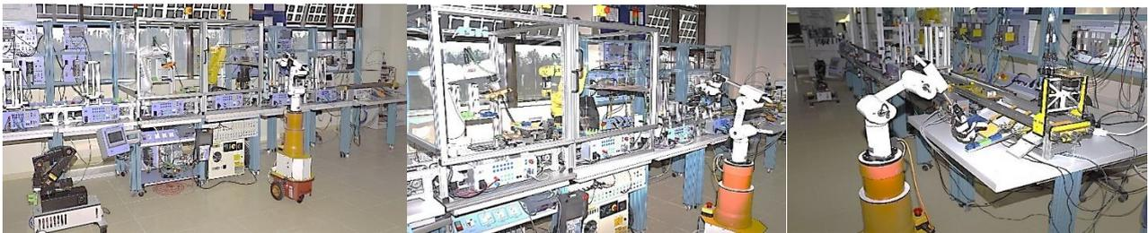
**Figure 6.** Linia de fabricație flexibilă de precizie, de laborator, asistată în procesul reversibil de dezasamblare de SAC-VAM (2DW/1FW), robot mobil echipat cu Manipulator 6-DOF, cu conducere integrată în tehnologii de asistare
