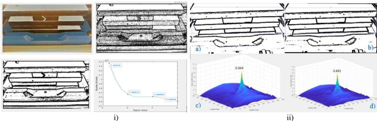
**Figura 2.** i) Influența parametrului Sigma- abaterea standard a filtrului gaussian, asupra numărului de pixeli detectați; ii) Rezultatele obținute cu privire la implementarea algoritmului MASC și aplicarea corelației încrucișate normalizate: a) imaginea prelevată b) imaginea prelevată asupra căreia s-a aplicat algoritmul MASC c) indicele maxim de corelație încrucișată pentru imaginea prelevată, d) indicele maxim de corelație încrucișată urmat de suprapunerea algoritmului MASC.
