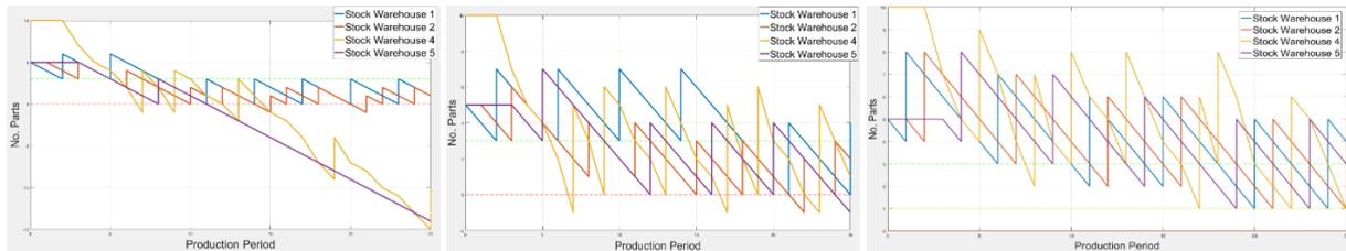
**Figura 8.** Evoluția stocului în magazii pentru a) aprovizionare insuficientă; b) supra-aprovizionare; c) stoc optimizat
