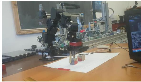
Fig. 5.6 Testarea în condiții de laborator a manipulatorului robotic cu 7DOF utilizând cutii ce au atașate coduri QR.
