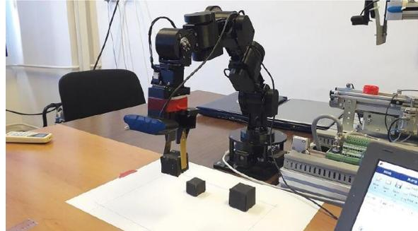
Fig. 5.7 Testarea în condiții de laborator a manipulatorului robotic cu 7DOF utilizând cutii de dimensiuni/înălțimi diferite.
